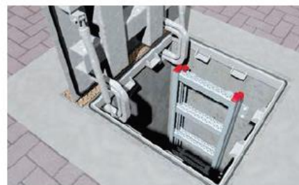
Лестницы в колодцах
